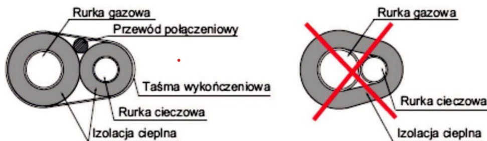
Rysunek 1 Sposób izolowania rurociągów
